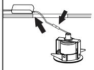
Após ligar o driver conecte os fios da luminária e coloque-o dentro do forro.
